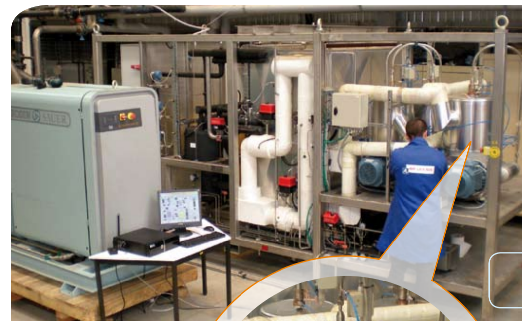
En gros plan, un des pulse tubes du prototype de démonstration, en test sur le site des Techniques Navales de la DGA à Toulon. Close up, one of the pulse tubes prototypes, tested at the Naval Techniques site of the DGA at Toulon.
