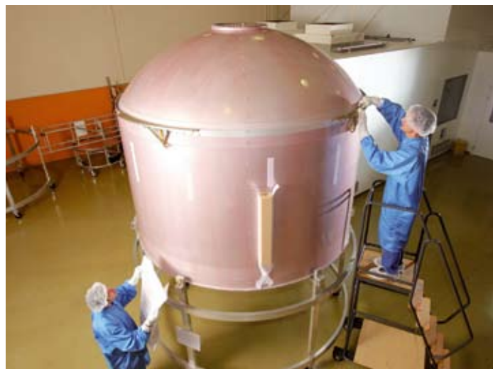
En fabrication sur le site d'Air Liquide DTA, un réservoir d'oxygène liquide.
