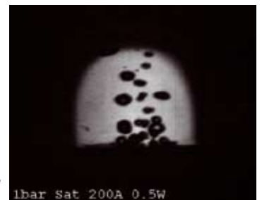
Évolution de la taille des bulles d'oxygène liquide en fonction de la gravité résiduelle.
