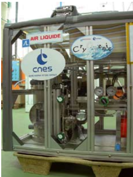
Le rack d'expérimentation avec, sur le côté gauche, le cryostat identifiable par la présence d'un hublot.
