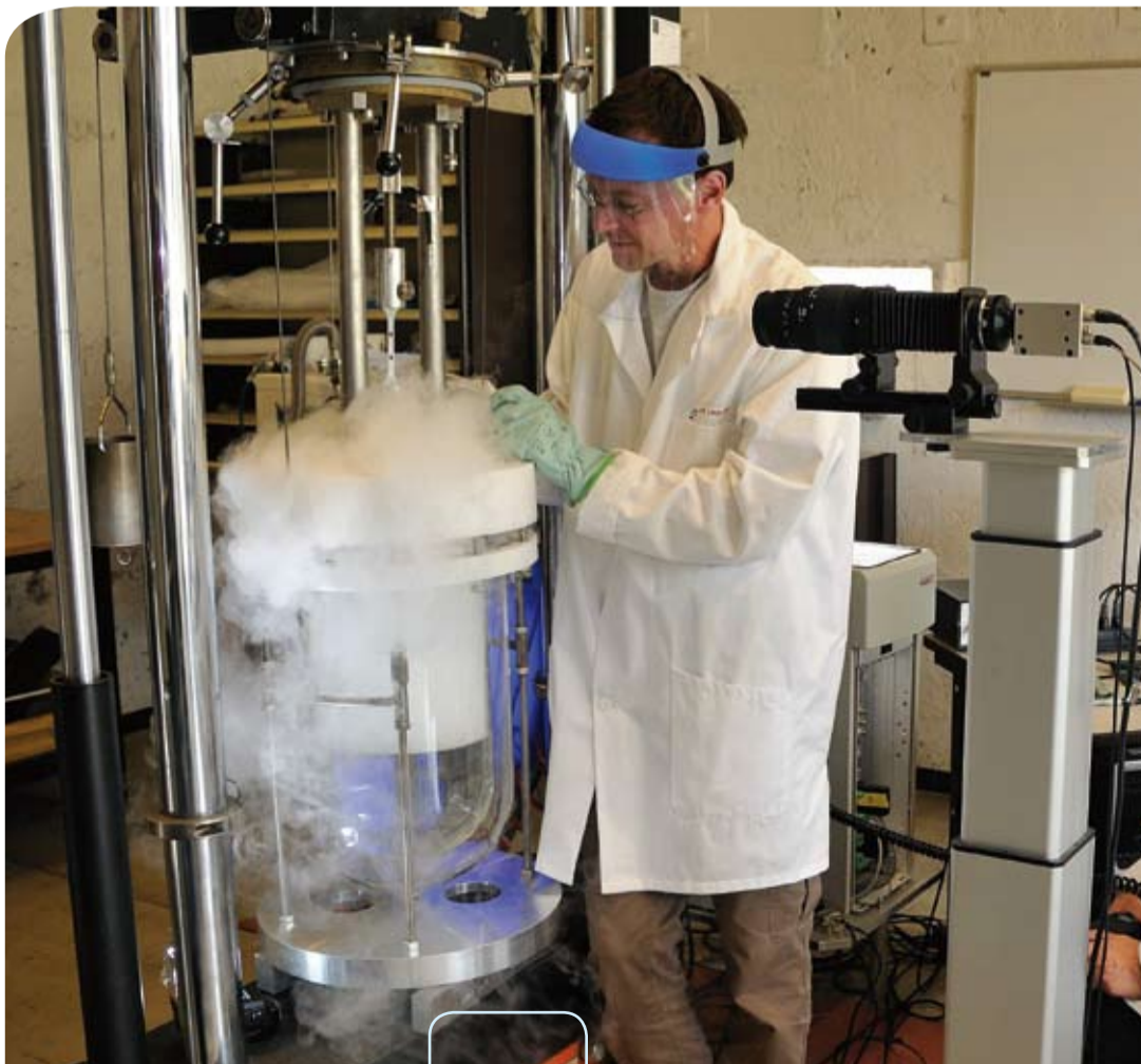
Un cryostat transparent pour concevoir un nouveau système d'essais vidéo. A transparent cryostat is being used to develop a new system for video tests.
